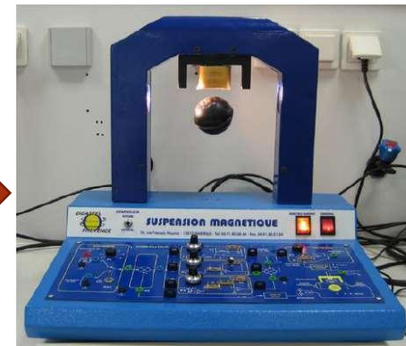
La suspension magnétique Didastel
